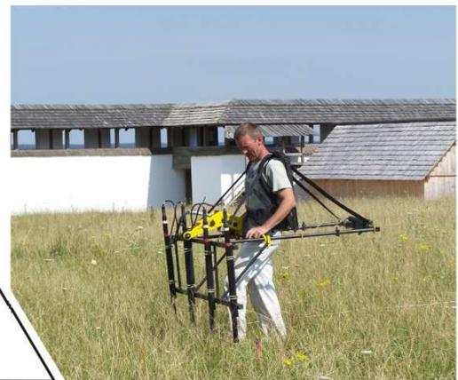
Vier-Kanal-Gradiometer FEREX bei der Messung
